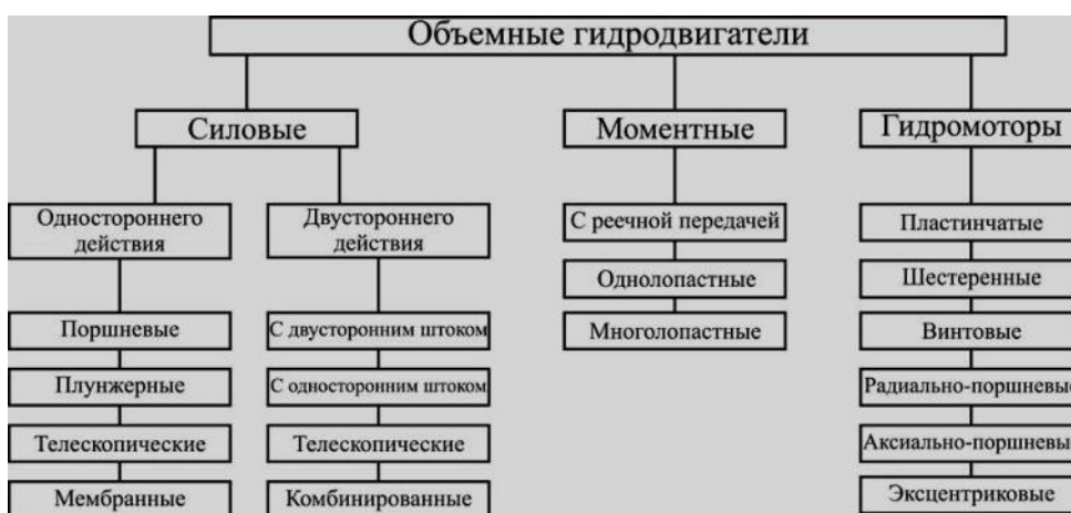
Рис. 5.1. Классификация объемных гидродвигателей
