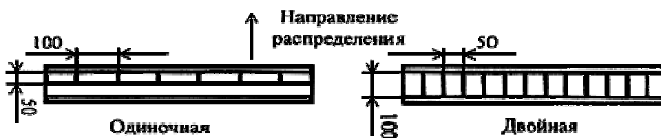
Рис.Е.2. Одиночная и двойная схема установки ванночек в шаблон (размеры в мм)
